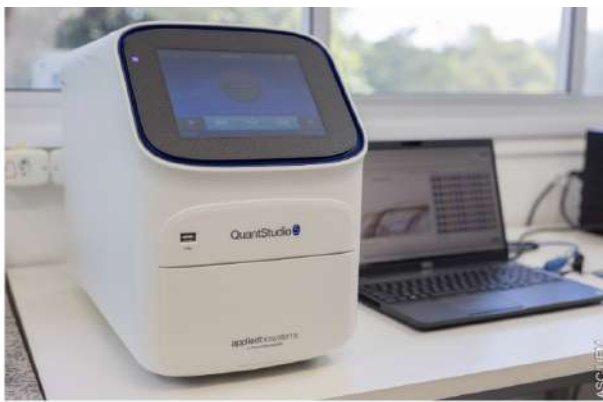
Termociclador em tempo real QuantStudio 5, cedido pelo Ministério da Saúde, processa as amostras de dengue do tipo "pesquisa da arbovírus" no Lepac/UEM
